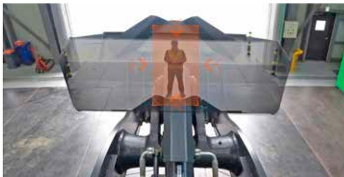
Ein weiterer Vorteil des transparenten Schaufelsystems liegt darin, dass es die Arbeitseffizienz erheblich verbessern kann, indem es dem Fahrer beim Be- und Entladen oder beim Transport von Materialien wie Zuschlagstoffen, Sand und Erde eine Vorwärtsperspektive bietet.
