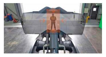
Ein weiterer Vorteil des transparenten Schaufelsystems liegt darin, dass es die Arbeitseffizienz erheblich verbessern kann, indem es dem Fahrer beim Be- und Entladen oder beim Transport von Materialien wie Zuschlagstoffen, Sand und Erde eine Vorwärtsperspektive bietet.
